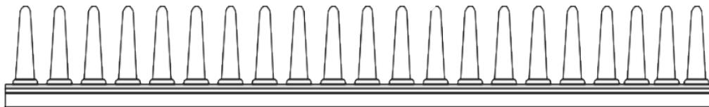
Igelstäbe im H-Profil gibt es auf Flachstahl, hier ist eine Breite bis zu 2000mm möglich, bei beliebigem Lochabstand und Riemenanzahl.
